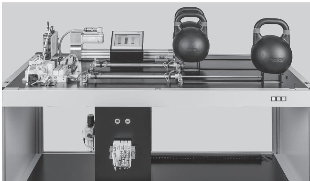
エネルギー効率の高い空気圧 - Controlled Pneumatics と Motion Terminal VTEM でさらに優れたエネルギー効率を実現します！圧縮空気は実際の需要に応じて動作に必要な量だけ供給されます。
