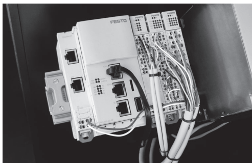
アクチュエータはオートメーションコントローラ CPX-E のモジュールで制御
