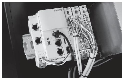
Die Ansteuerung der Aktoren erfolgt über Module am CPX-Terminal.
